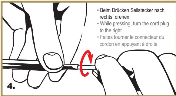
**Schritt 4:** Während Sie drücken, drehen Sie den Seilstecker ungefähr um 1 mm nach rechts bis er arretiert (Bild 4). So sitzen Seil und Nadel perfekt zusammen.
