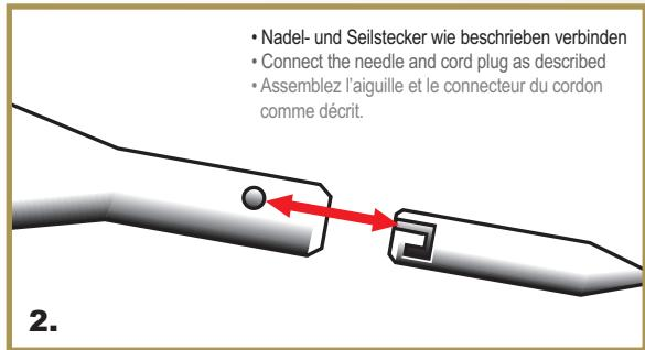
**Schritt 2:** Die offene Aussparung des Seilsteckers und der eingelassene Punkt auf dem Nadelende müssen exakt zueinander stehen (Bild 2), damit Sie die Nadel einfach arretieren können.
