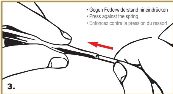
**Schritt 3:** Stecken Sie den Seilstecker (Bild 3) ca. 2 mm tief in die Nadel hinein. Dabei drücken Sie die Sicherungsfeder in der Nadel etwas zusammen, wofür Sie u. U. bei der ersten Benutzung etwas mehr Kraft benötigen.
